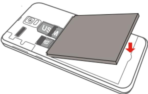
4. 将手机后盖轻轻放在机身上，并按下图中箭头所示向下压合，直到与机身完全契合。
