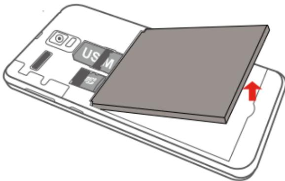
4. 按下图中箭头所指方向取出 USIM 卡和存储卡。
